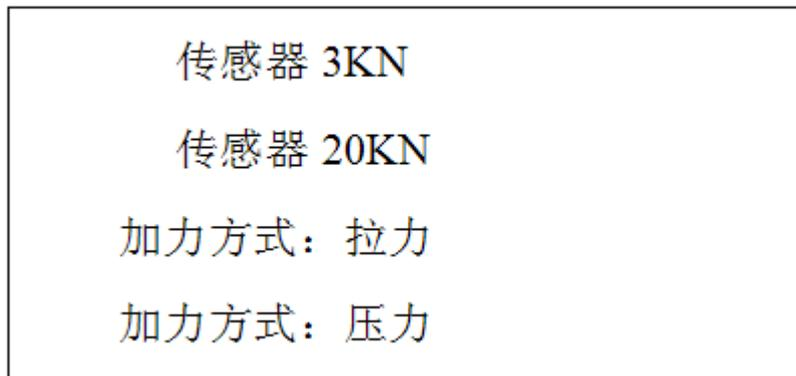
(3) 进行测试按测试键，用(↑)(↓)选择传感器，光标移到所在位置，按确定键进入所需测试项目，用(↑)(↓)选择测试项目，光标移到所在位置，按确定键进入所需测试。
