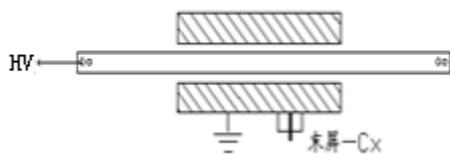
图 6-7 套管接法
