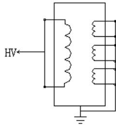
**图 6-6 CT 接法****c、一次侧对二次侧及地****A、接线见图 6-6****B、电压为 10KV****C、反接法****8、高压穿墙套管****a、芯棒对末屏 (常用)****A、解开末屏接地****B、接线见图 6-7****C、电压为 10KV****D、正接法**
