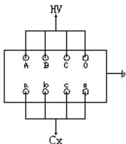
图 6-9 变压器接法
