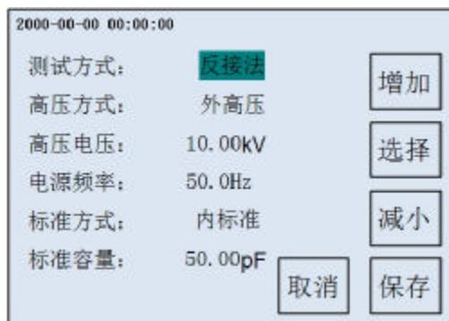
c、外电压—内标准—反接法
