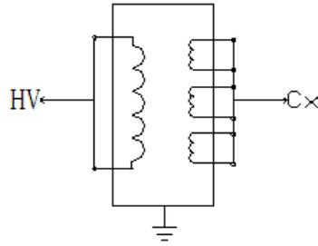
**图 6-5 CT 接法****b、一次侧对末屏 (常用)****A、接线参考图 6-6****B、电压为 10KV****C、反接法**
