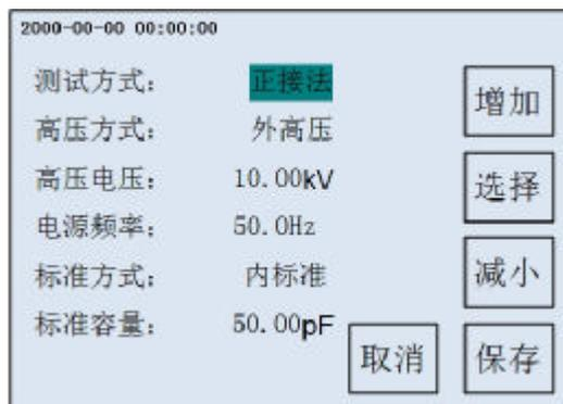
d、外电压—外标准—正接法（必须先设置好外标准容量）
