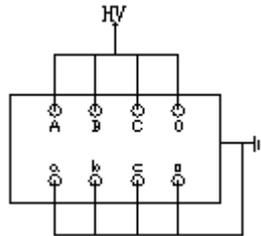
图 6-10 变压器接法
