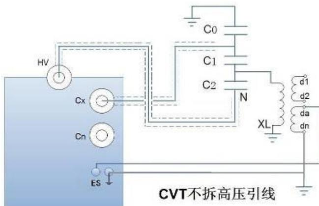
d、反接屏蔽法测量 CVT 上端 C0 的电容值和介损测量模式：反接法。电压 $\leq 2\text{kV}$
