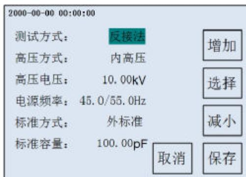
d、外电压—外标准—反接法（必须先设置好外标准容量）
