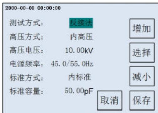
b、内电压—外标准—反接法（必须先设置好外标准容量）
