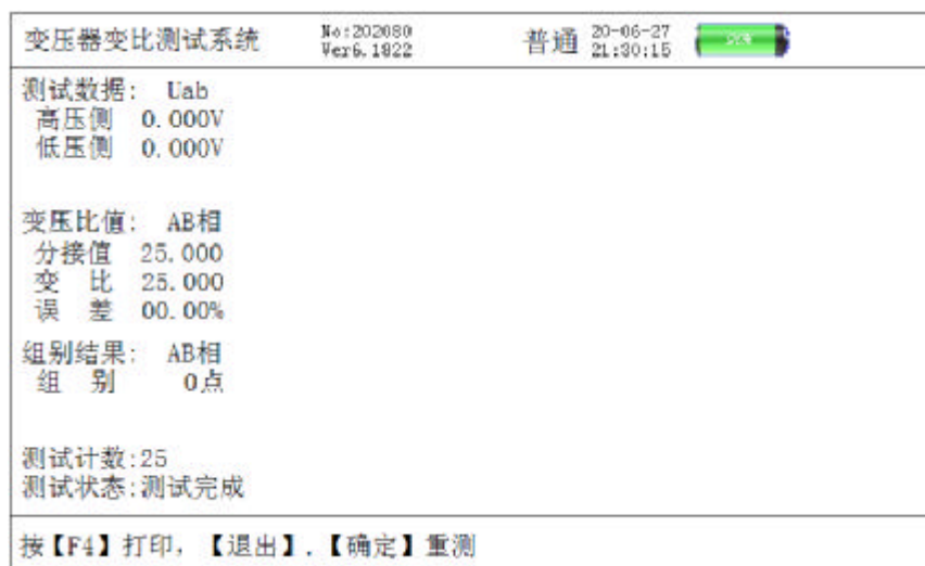
图十、单相变压器测试接线结果屏
