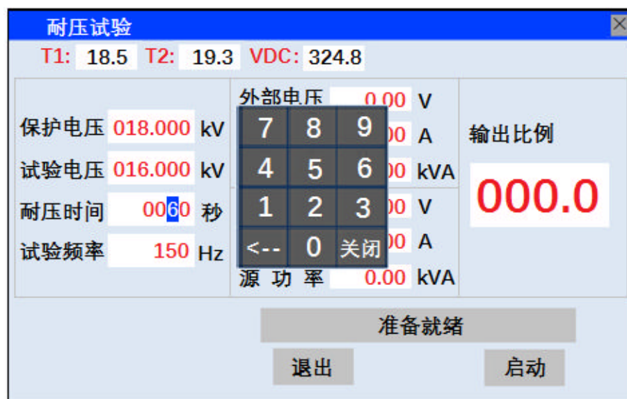
耐压试验启动前修改 图 4-6
