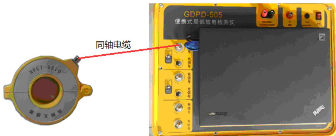
图 5.1 高频电流互感器接线图
