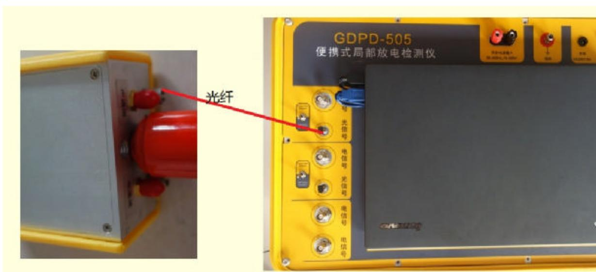
图 5.4 声电一体式传感器接线图
