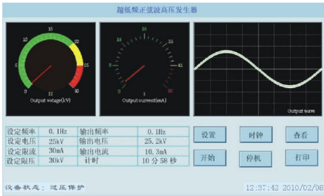
图 12 控制器提示过压保护
