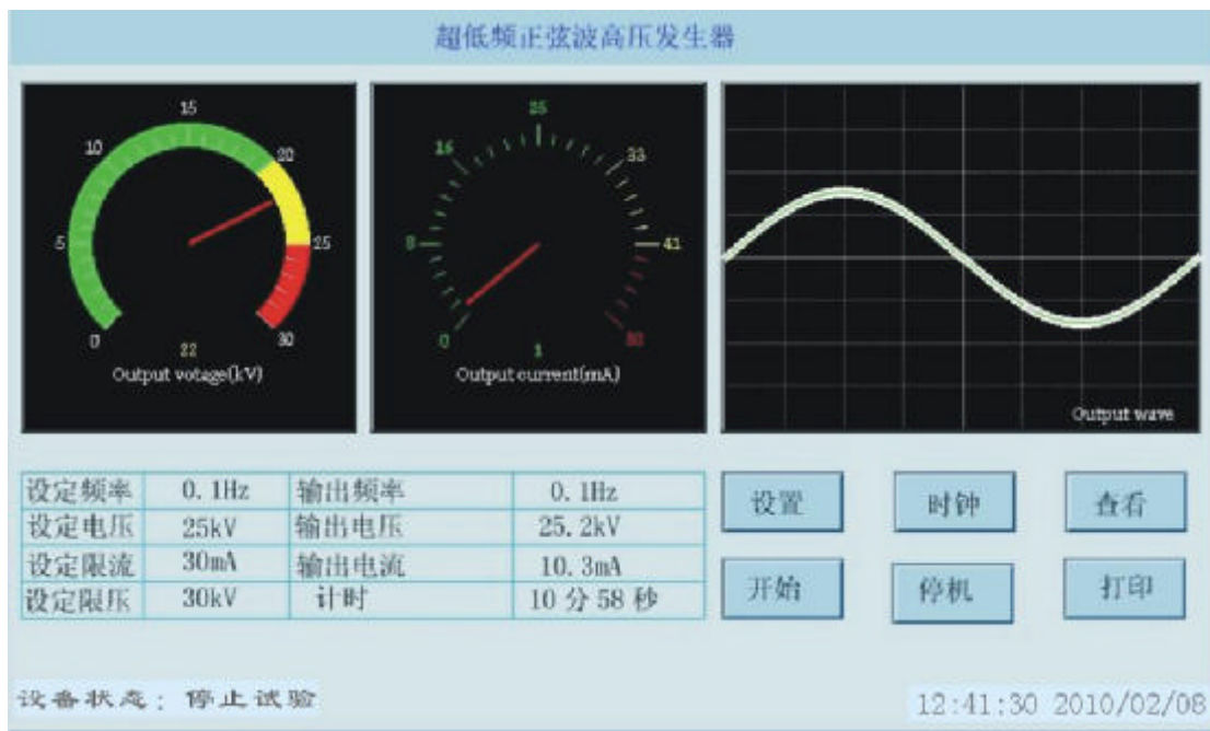
图 9 控制器提示停止试验
